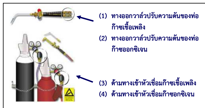
รูปที่ ๗ ตำแหน่งการติดตั้งอุปกรณ์ป้องกันไฟย้อนกลับ
