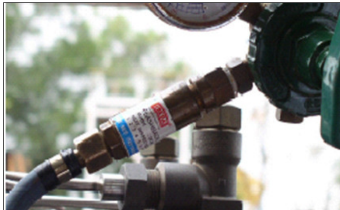
รูปที่ ๗ ตำแหน่งการติดตั้งอุปกรณ์ป้องกันไฟย้อนกลับ
